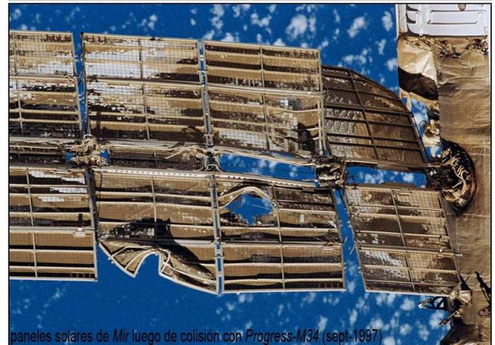
paneles solares de Mir luego de colisión con Progress-M34 (sept. 1997)
