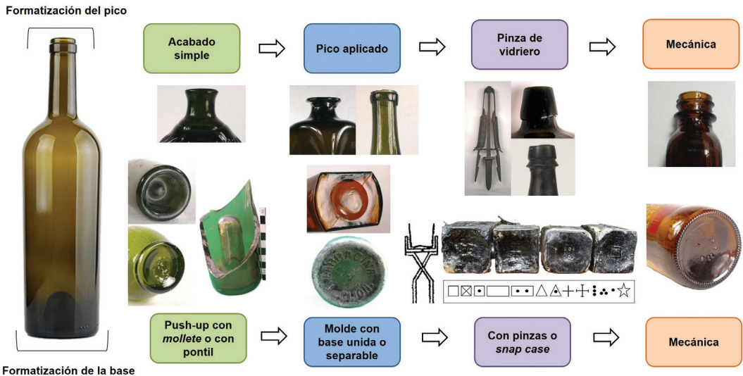
Figura 7.3 Evolución en la formatización de la base y el pico en botellas
